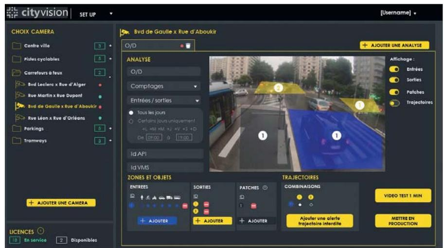
*Wintics et Aéroports de Paris : supervision des quais de l'Orly bus et suivi de la dépose minute d'Orly grâce au logiciel Cityvision qui analyse en temps réel les flux vidéo des caméras.*
