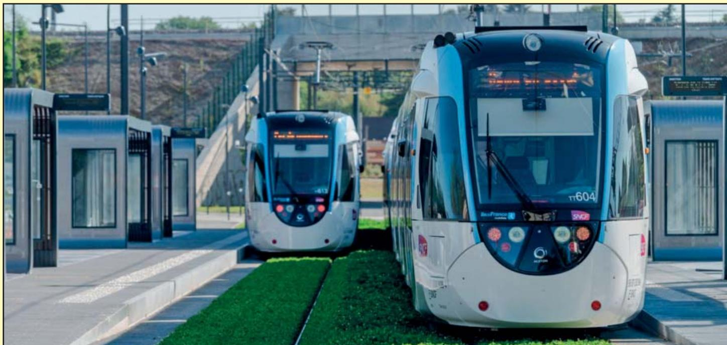
Un tramway 2-en-1 qui circule à la fois sur des voies de tramway classiques, en milieu urbain et sur les voies du réseau ferré.
