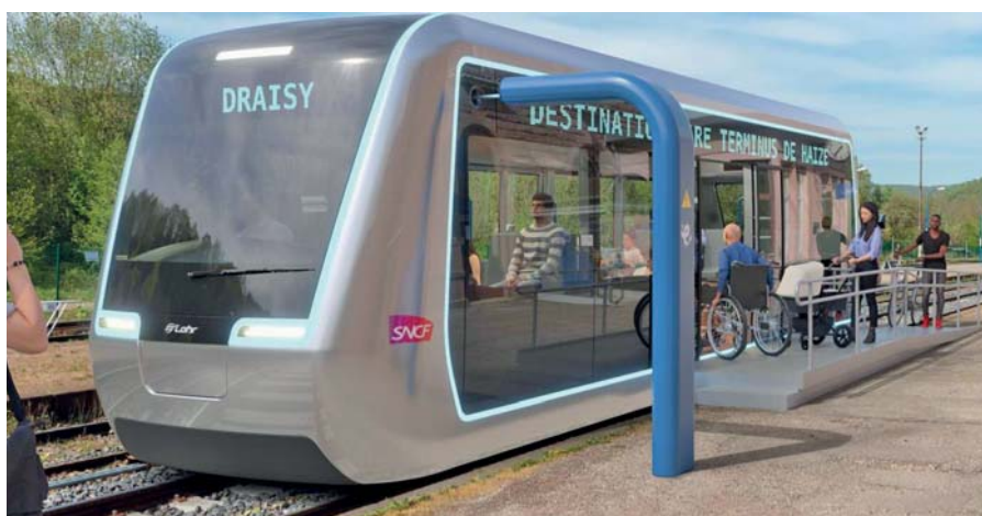
Destinée aux petites lignes ou tronçons de lignes à faible trafic, la solution Draisie repose sur un train modulaire de 30 places assises de la taille d'un bus.
