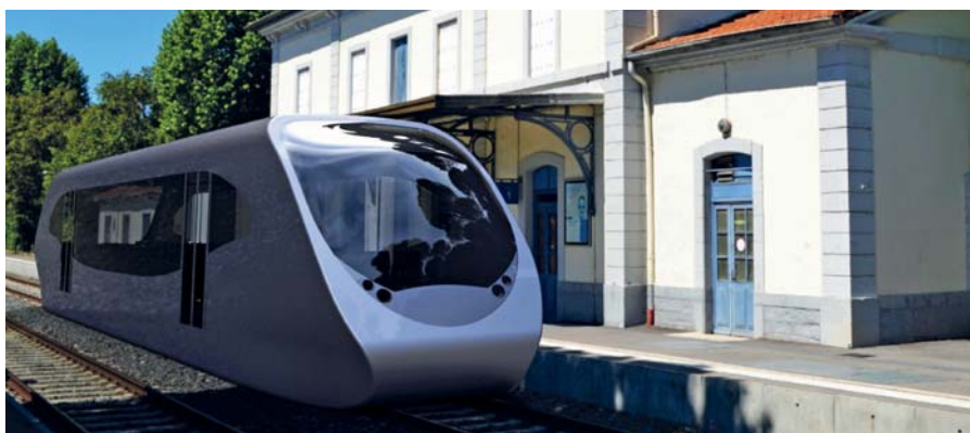
Le projet Ecotrain est un système de navettes autonomes ferroviaires légères alimentées par batterie et permettant d'assurer une circulation automatisée sans conducteur.
